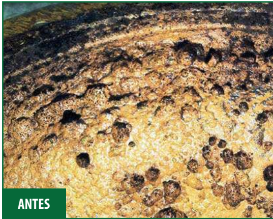
Cabezal flotante del intercambiador de calor antes y después de rellenar los hoyos en acero con Novocoat EP3900 Machinable Paste . Novocoat SC5400 Tank Lining aplicado como capa superior.
